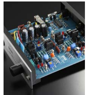
SRM-252SのディスクリートDCアンプ構成
